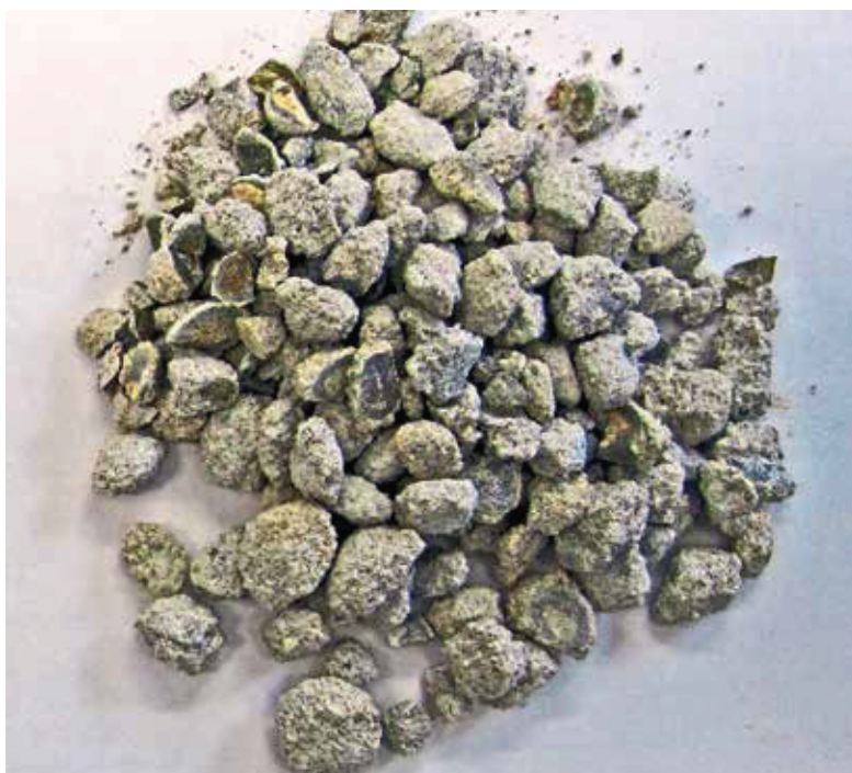
Aus dem Bettungsmörtel separierte Zementlinsen.
