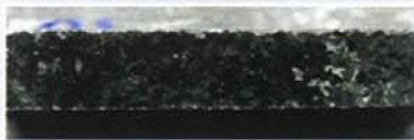
Bild 3: Gabbro (polierte Oberfläche) nach ChemTest mit Antical – Probenvorlagerung trocken. Geringe Oberflächenveränderung – geringe Glanzveränderung (C2). Die Feldspäte der Plagioklasreihe sind durch die Säureeinwirkung geschädigt und erscheinen weiß. In Prüfflüssigkeit eingetauchter Gesteinsbereich rechts im Bild. Bildbreite ca. 40 mm.
