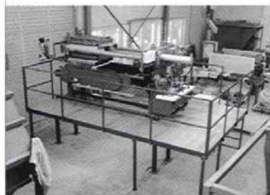
Kammerfilterpresse mit Podest und Laufsteg, 1,5 Platten, Kammervolumen 86l, Trocknungsleistung 2,5m 2 /8h
