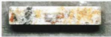
Bild 2: RAPAKIWI Granit (polierte Oberfläche) nach ChemTest mit Antical – Probenvorlagerung trocken. Keine Oberflächenveränderung (C1). In Prüfflüssigkeit eingetauchter Gesteinsbereich rechts im Bild. Bildbreite ca. 40 mm.
