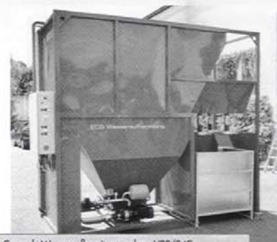
Kompakt Wasseraufbereitungsanlage V20/S4C. Reinigungsleistung 180l/min.
